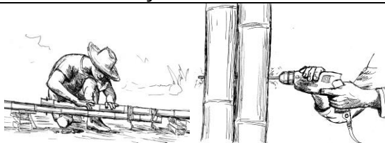
Fig. 41– Montagem das terças
